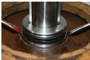
Рис. 18: Извлечение торцового уплотнения с помощью монтировок
